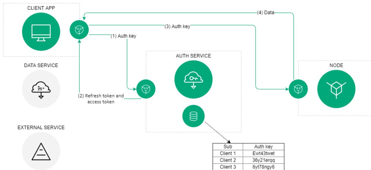
Рис. 2: Схема авторизации на блокчейнплатформе Waves Enterprise
