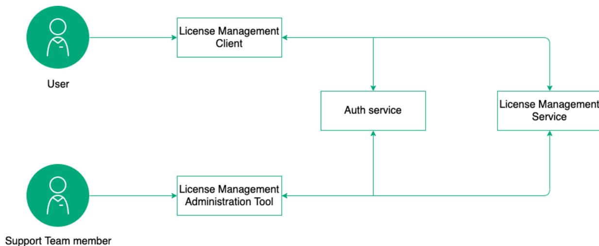
Рис. 1: Схема получения лицензии блокчейнплатформы Waves Enterprise
