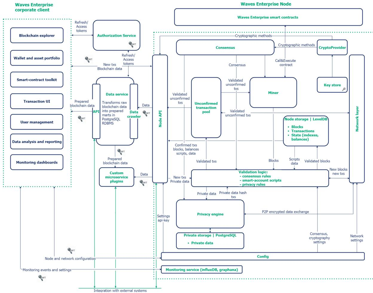
Рис. 2: Подробная схема архитектуры ноды и дополнительных микросервисов
