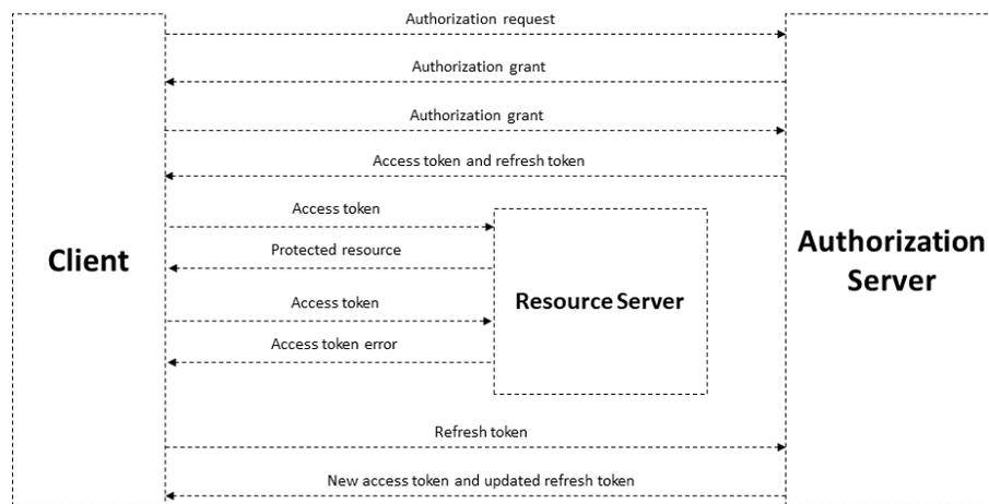
Рис. 1: Общая схема авторизации на базе протокола OAuth 2.0
